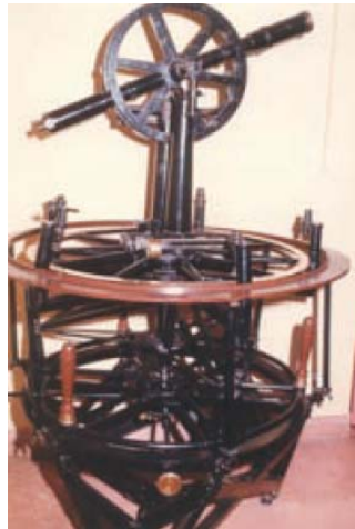
شكل (٣-١) نماذج لأجهزة ثيودوليت قديمة لقياس الزوايا
